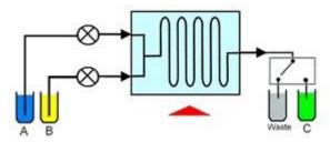
为了促进所需的反应,通常混合装置和反应器都要维持在一个合适温度。但是,为了促进电化学或光化学反应,也会将反应物暴露于电通量或者光子通量中。
