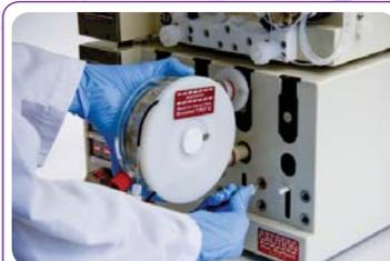
Le remplacement des réacteurs s'effectue en quelques secondes, sans le moindre outil
