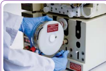
Los reactores se pueden cambiar en segundos, sin herramientas
