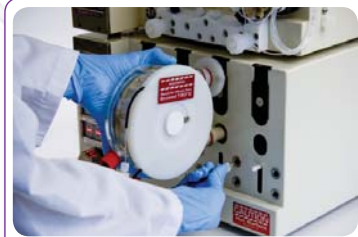
Reaktoren können in Sekundenschnelle ohne Werkzeuge ausgetauscht werden.
