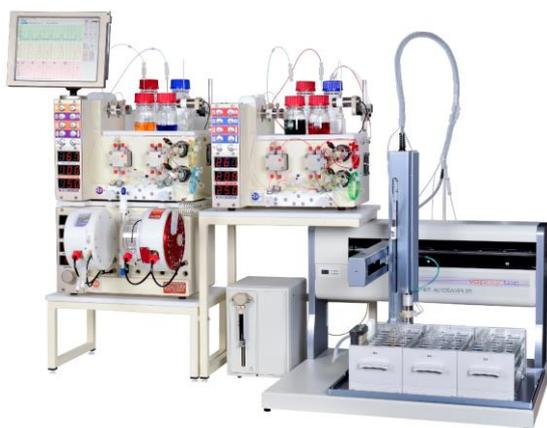
Chargez différents réactifs pour chaque cycle de réaction, si nécessaire. Pour la synthèse de bibliothèque ou le filtrage des catalyseurs.
