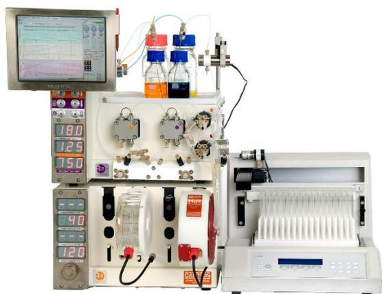
À l'aide d'un collecteur de fractions, l'utilisateur peut mettre en attente une séquence de réactions, puis laisser le système sans surveillance pendant qu'il les fait tourner.
