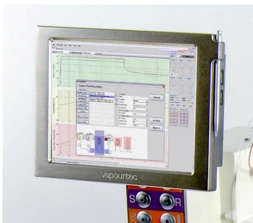
このソフトウェアは専用タッチパネルまたは Windows PC で稼働し、R シリーズ・システムを完全な自動最適化プラットフォームにすることができます。
