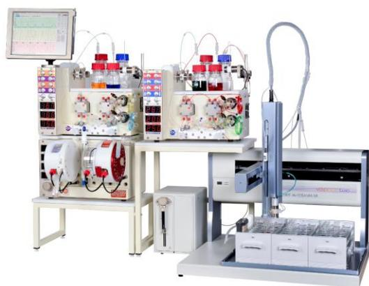
必要に応じて、各反応サイクルごとに異なる試薬を注入できます。ライブラリの合成や触媒のスクリーニングに対応。
