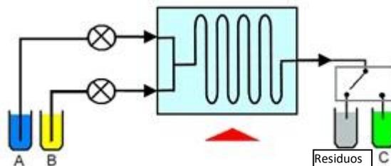
El dispositivo de mezcla y el reactor por lo general se mantienen a la temperatura idónea para propiciar la reacción deseada. Sin embargo, los reactantes también pueden exponerse a un flujo eléctrico o un flujo de protones para propiciar la reacción electroquímica o fotoquímica.
