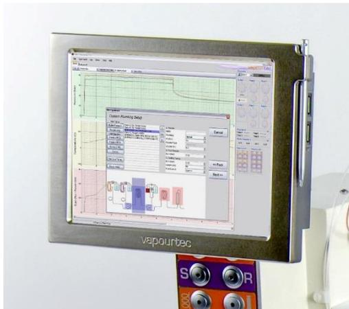
Este software que funciona en un panel táctil dedicado o en un PC Windows, convierte al sistema R-Series en una plataforma de optimización totalmente automatizada.
